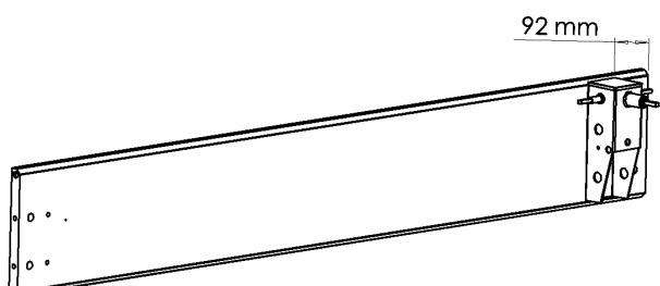
Frontplade med gear samles med højre søjle, husk trækstang mellem gear og søjle
