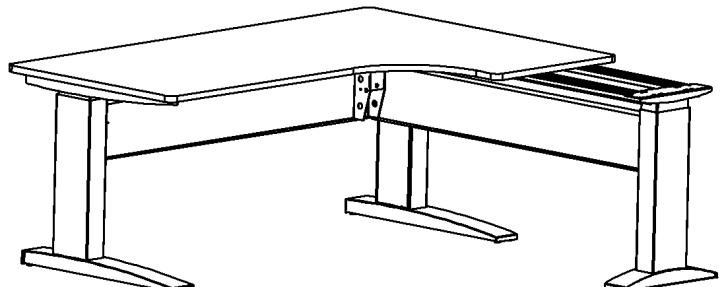
Tillægsplade placeres på traverser og skrues fast. Inden dette gøres kontrolleres det, at de to frontplader står vinkelret på hinanden
